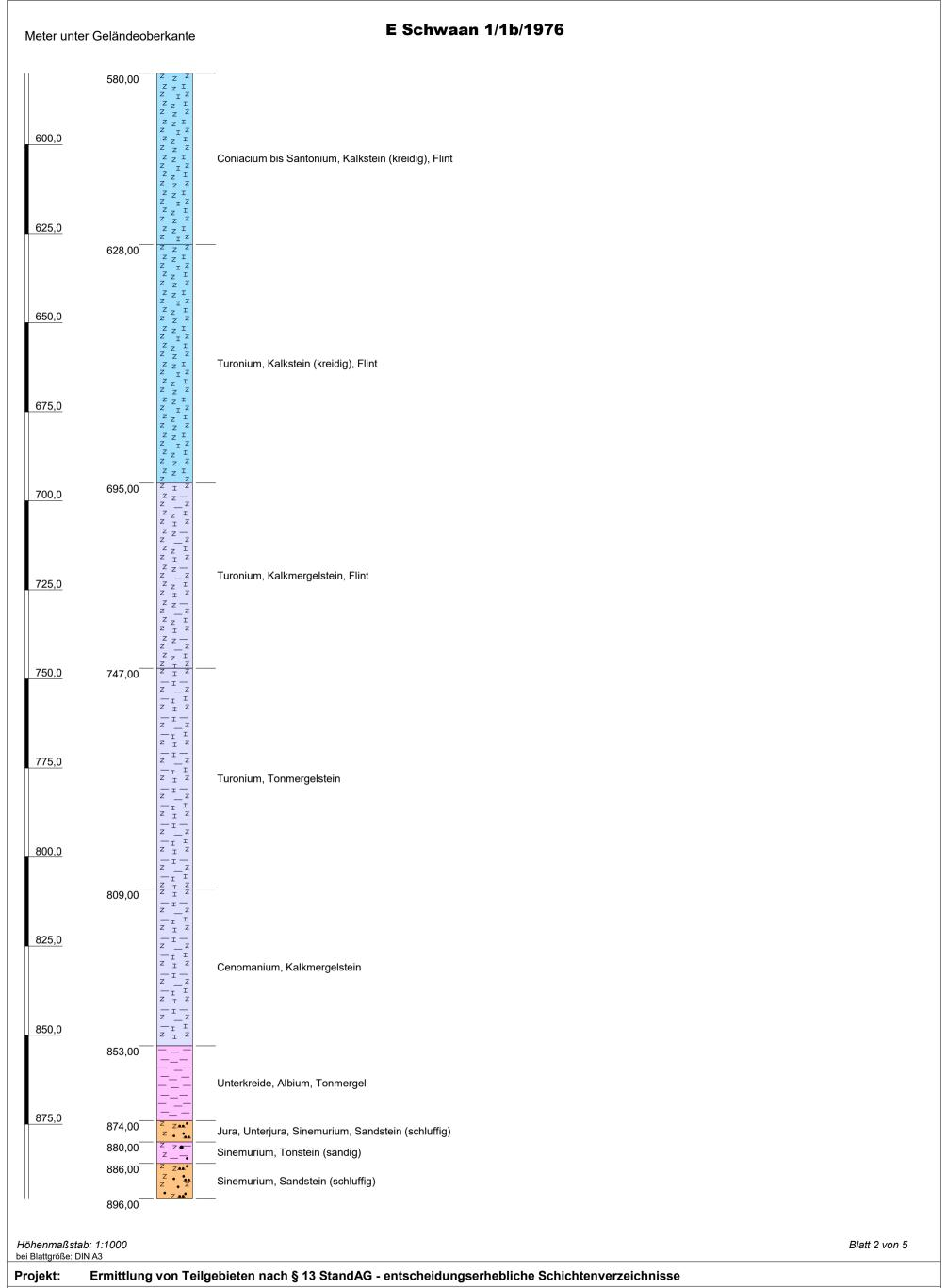
Bohrung: E Schwaan 1/1b/1976
