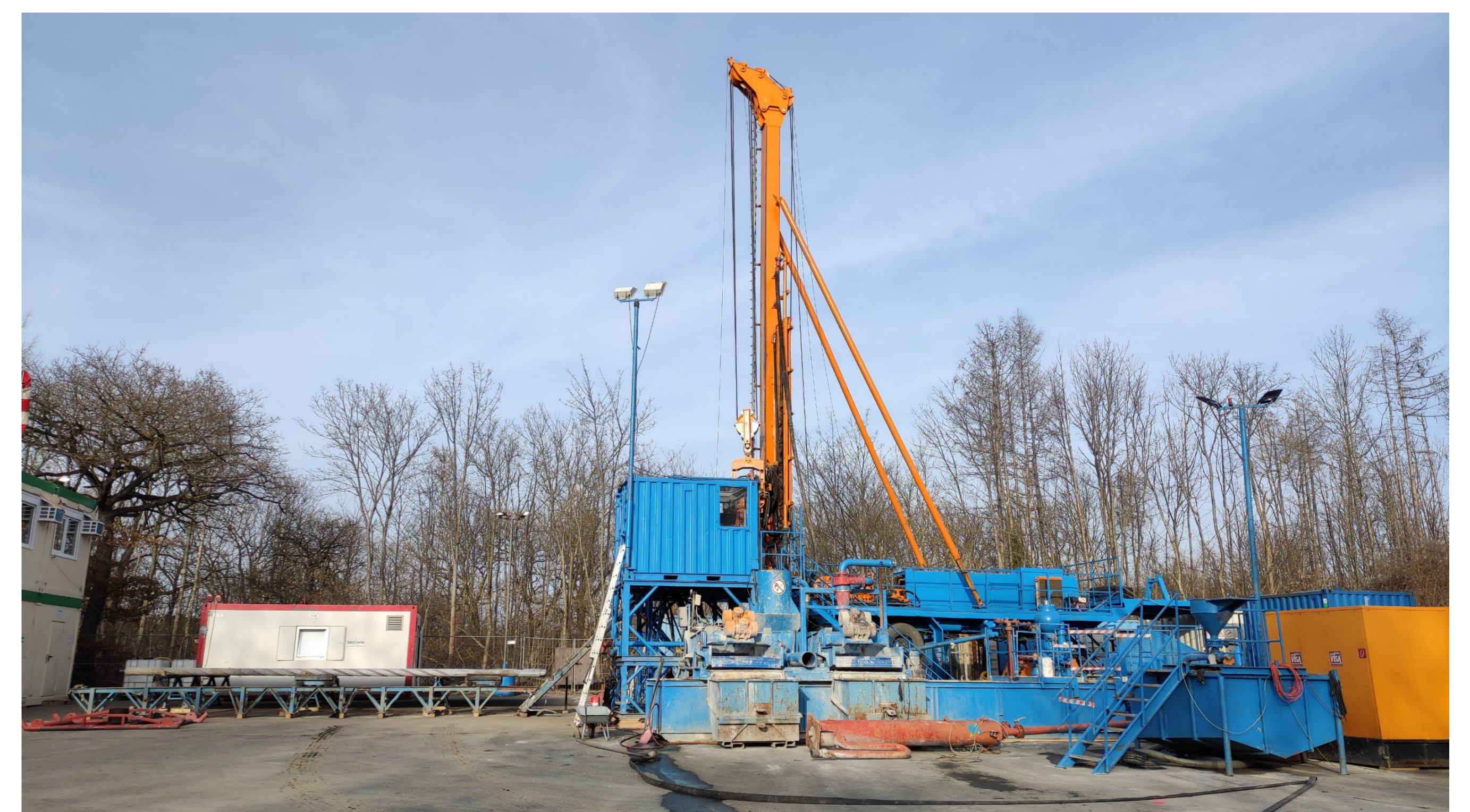
Abb. 3: Ein Bohrplatz, von dem aus eine Bohrung in den Untergrund abgeteuft wird. Im Bild oben links Bohrkerne (Gesteinsproben) des Gesteins im Untergrund, welche nach der Entnahme untersucht und analysiert werden. Quelle: BGE
