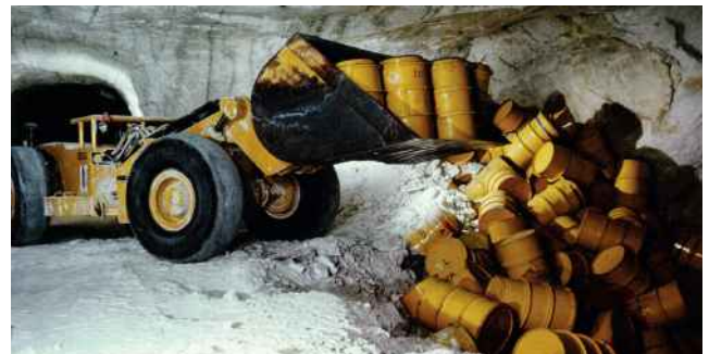
▲ Einlagern von Abfallfässern mit Versturztechnik (1975)
