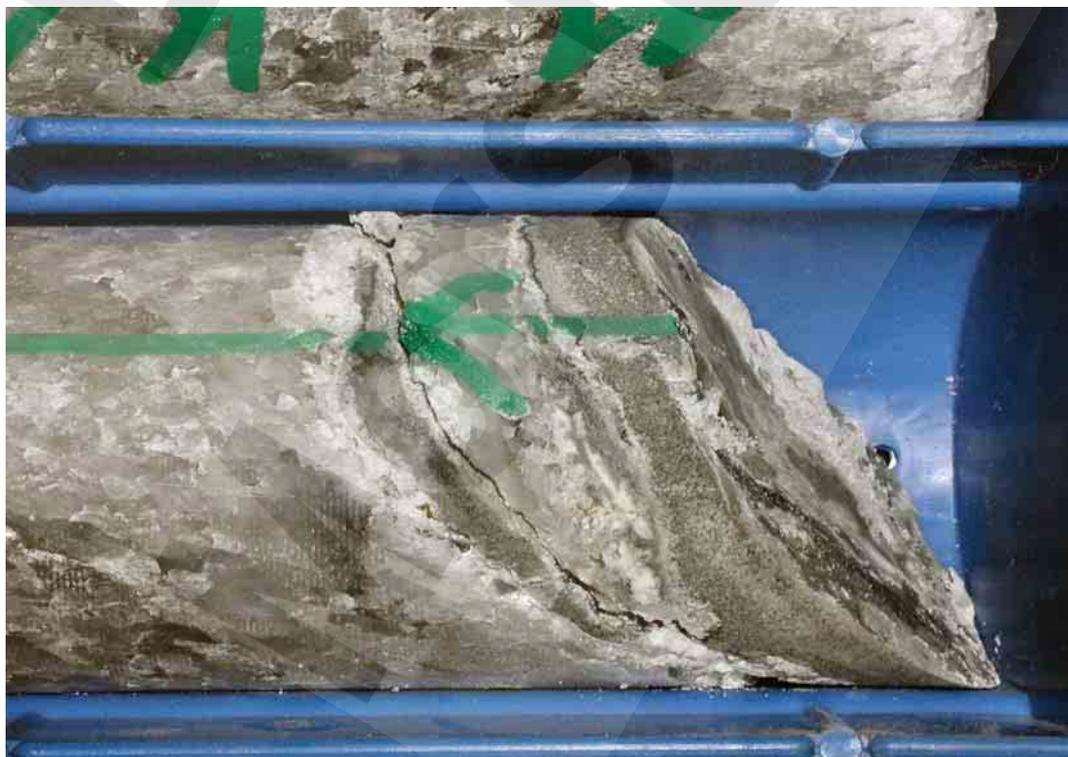
Abbildung 2: Bohrung 12YER22/RA304 Kernmarsch 3, mit Salzbeton gefüllter Riss
