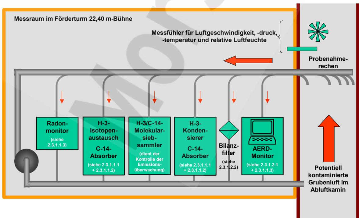
Abb. 2.2: Schematische Darstellung der Abluftprobenahme und -messung
