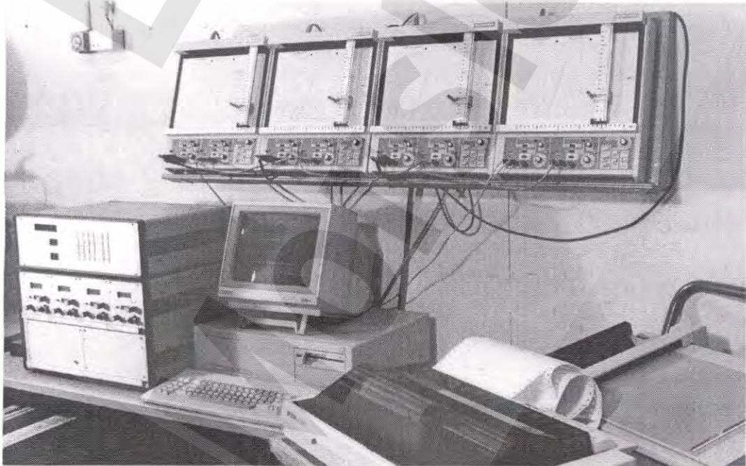
b) Messwerterfassung mit Messverstärker, Datalogger, x-y-Schreibern, PC
