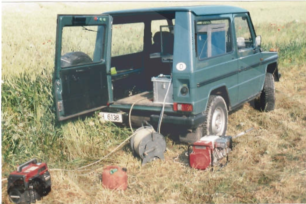
Abb. 5.5: ERA Morsleben; Radiohydrometrische Einbohrlochmessungen: Meßfahrzeug JEEP für Messungen in geringen Tiefen (bis ca. 50 m u.G.) und 2"-Verrohrungen
