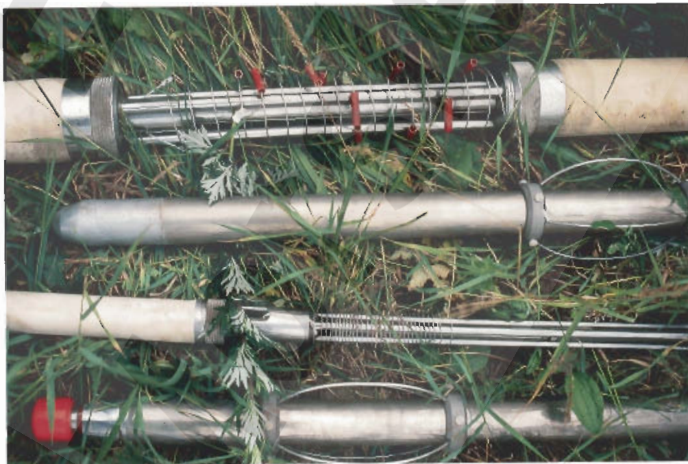
Abb. 5.6: ERA Morsleben; Radiohydrometrische Einbohrlochmessungen: Tracer-(Verdünnungs-) und Richtungssonden für den Einsatz in 2 1/2" und 4 1/2" Verrohrungen. Gut erkennbar sind die Mischspiralen zum homogenen Verteilen der radioaktiven Tracerlösung in dem, durch die Packer isolierten, Meßbereich (50 cm)
