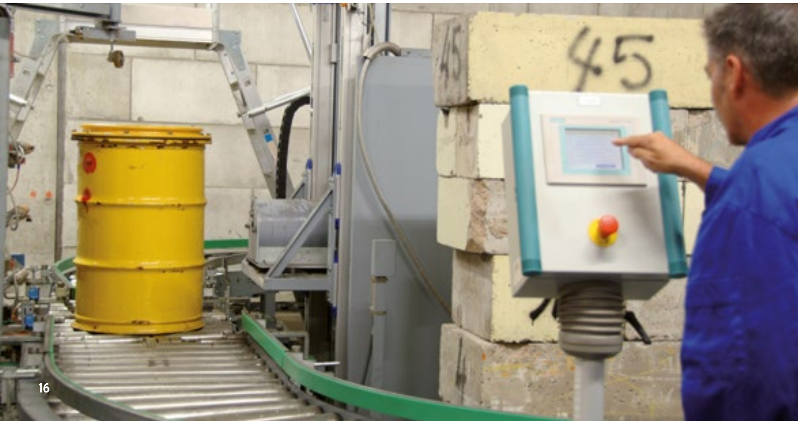
Die Fassmessanlage in Karlsruhe. Die Abfälle unterliegen strengen Kontrollen. Hier misst ein Mitarbeiter die Ortsdosisleistung an der Fassoberfläche.
