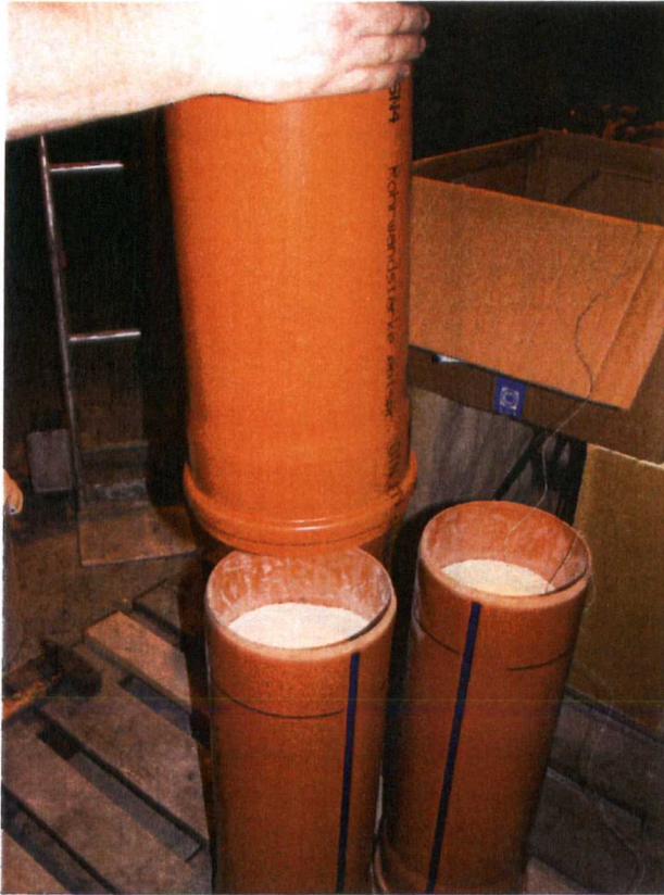
Abb. 4.9: Zusammenbau der Säulen
