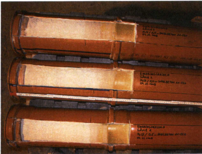
Abb. 4.11: Freigelegte Eindringbereiche der Säulen 1, 2 und 3
