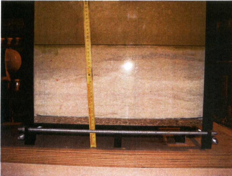
Abb. 4.6: Absenken des Sorelbetons am Kontakt Beton/Salzgrus
