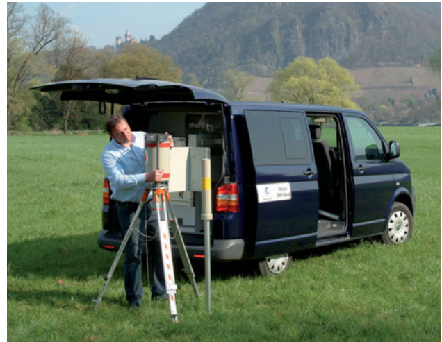
Mobiles Messsystem zur Ermittlung der auf dem Boden abgelagerten Radionuklidmengen
