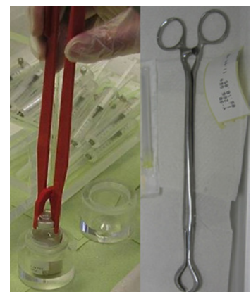
Abb. 3: Greifer und Zange für Fläschchen
