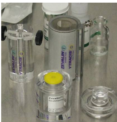
Abb. 1: Abschirmungen aus Acrylglas (Herst.: Biodex, Vertrieb: CIS Bio)
