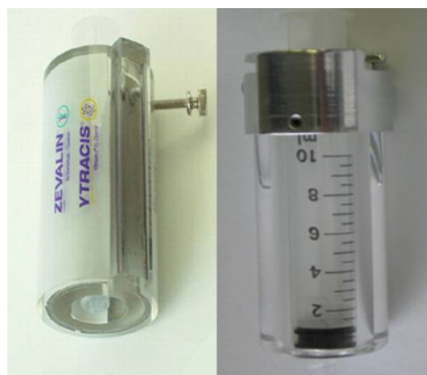
Abb. 2: Abschirmungen für 10 ml-Spritzen a: mit Blei-Inlay, b: ohne Blei-Inlay
