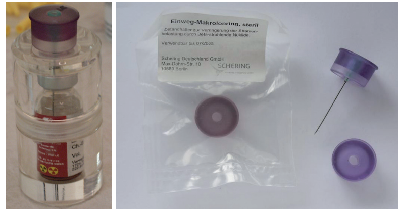
Abbildung 2: Plexiglasabschirmung mit Aktivitätsfläschchen und Kanüle mit Einweg-Makrolonring (Vertrieb: Schering / IBA Molecular)
