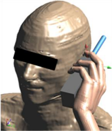
Abbildung 54 Duke und Motorola HRT – MTP 850 Funkgerät in Kipplage links mit Handmodell. Dieses Szenario ist in Abbildung 55 zusätzlich berücksichtigt.
